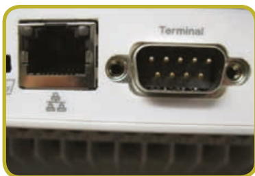
De gauche à droite : port RJ-45 pour Ethernet, port 9 broches pour RS 232 ou RS 485 ; fiche RJ-45 pour Ethernet et 9 broches pour RS 232 ou RS 485 ; bornier de raccordement pour RS 232 et RS 485
