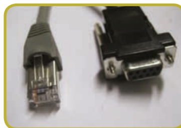
De gauche à droite : port RJ-45 pour Ethernet, port 9 broches pour RS 232 ou RS 485 ; fiche RJ-45 pour Ethernet et 9 broches pour RS 232 ou RS 485 ; bornier de raccordement pour RS 232 et RS 485
