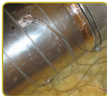
Ailes de mesure, avec détail des deux prises de pressions à droite
