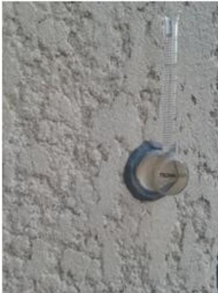
Permet de mesurer le facteur d'absorption d'eau liquide A
